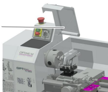
Img.1-5: protección del mandril del torno
