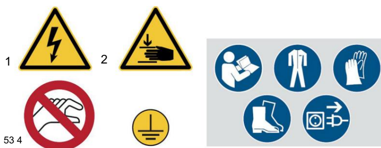
Fig. 1: Marcas de seguridad - 1 Advertencia de tensión eléctrica peligrosa - 2 Advertencia de peligro de aplastamiento durante el proceso de plegado - 3 Prohibición de tocar la máquina 4 Símbolo de tierra - 5 Información obligatoria: leer las instrucciones de funcionamiento, llevar ropa protectora, guantes protectores, calzado de seguridad y desconectar el enchufe.
