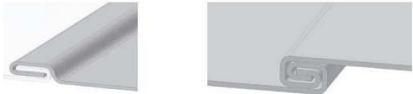
Fig. 18: Ejemplo: Costura de pliegue simple y costura de pliegue doble
