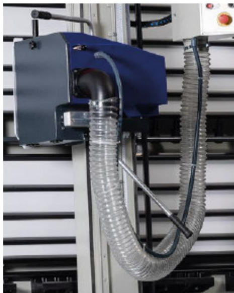
Figura 16: Montaje de la manguera de succión
